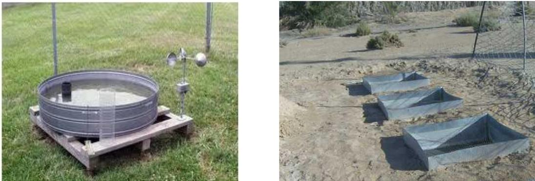
**Figure 1** Class « A » pan and Colorado pan
